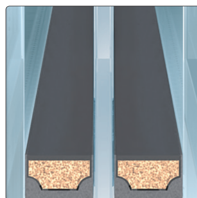
Warme Kante – thermisch optimierter Scheibenverbund \psi (Psi) bis 0,0030 W/(m 2 K)
