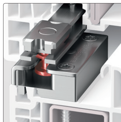
Pilkkopfbolzen hakt in Schließeteil ein | einfach und effektiv, Aushebeln ist im geschlossenen Zustand fast unmöglich.
