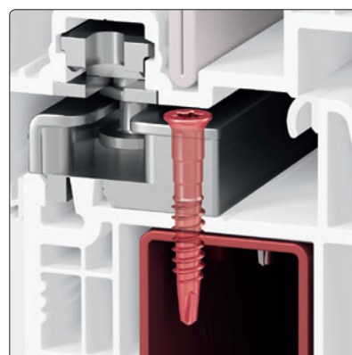
Die einatzgehärteten Sicherheitsschließteile werden mit zwei massiven Spezialschrauben im Stahlkern verankert.
